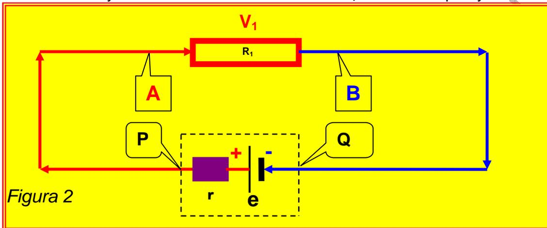
resistencia r interior a la pila.
